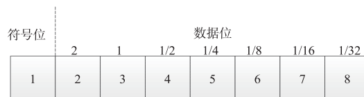
图4 八位二进制量化结构图
